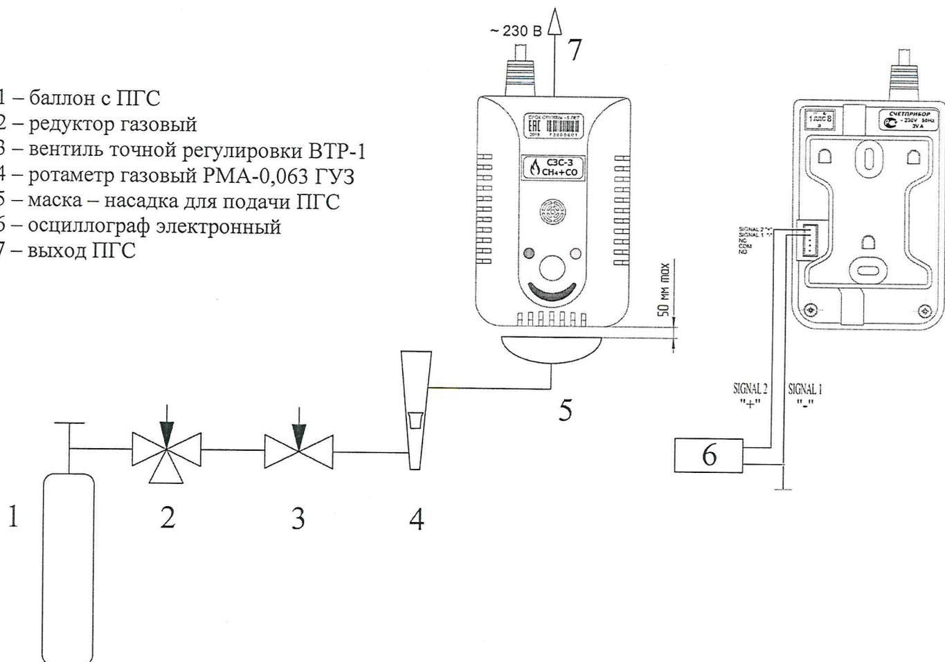
Схема поверки метрологических характеристик сигнализаторов загазованности «Счетприбор» СЗС
